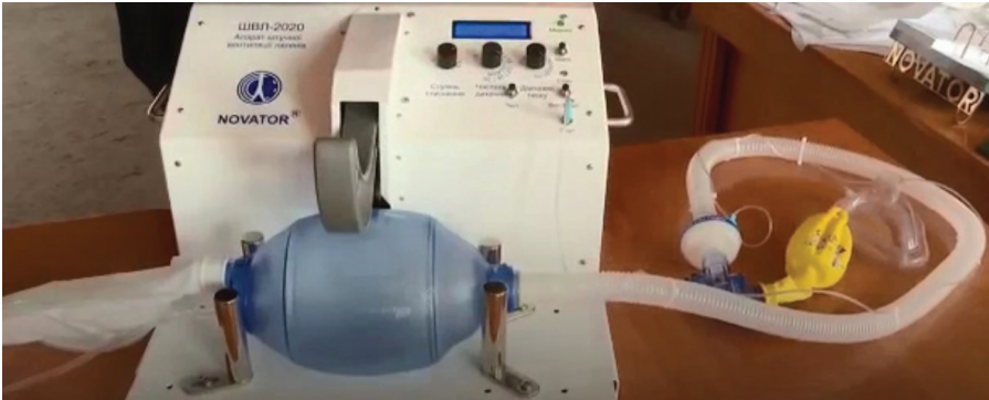
Рис. 1. Простейший аппарат ИВЛ, работающий на принципе объемного вытеснения газа из мешка
