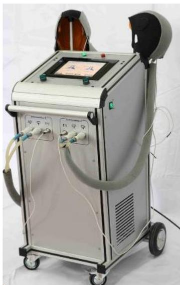
Рисунок 1А – Внешний вид аппарата терапевтической гипотермии АТГ-01 для краниocereбральной гипотермии
